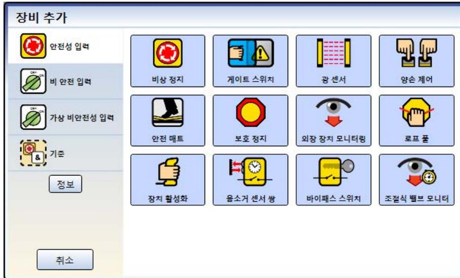
그림 51: SC10-2: 장비 보기에서 입력 추가(물리적 상태 출력은 이 보기에서만 추가 가능)
